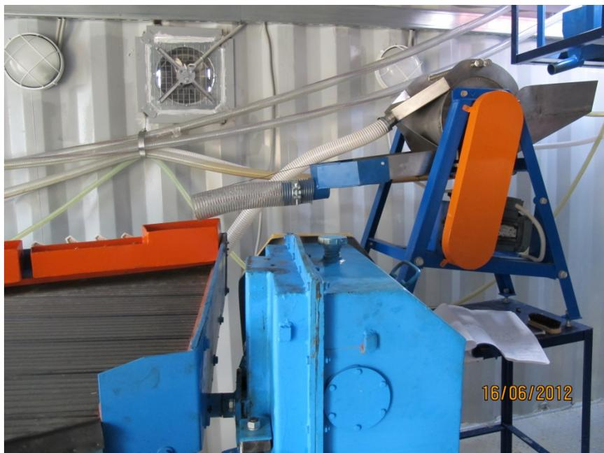
Мокрый магнитный сепаратор MMC-2PM в доводочном модуле ДМ-2
