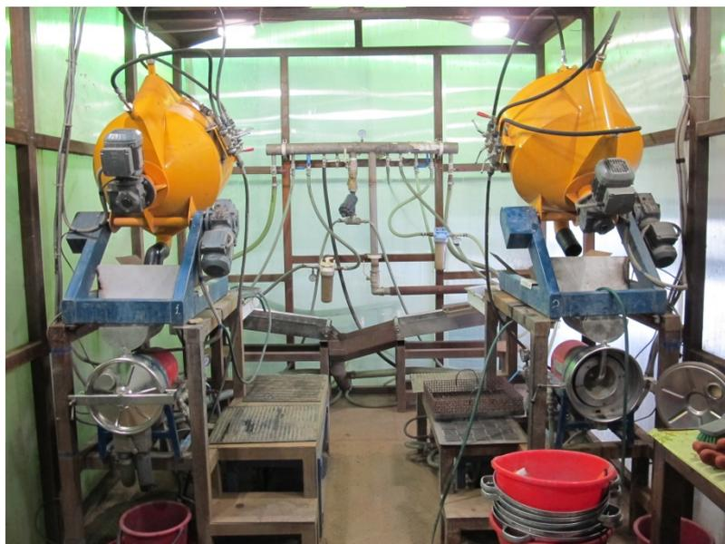
Высоконапорные бутары в геологоразведочном обогатительном модуле (ГРОМ.)
