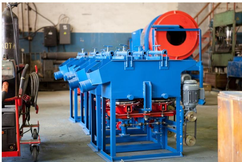
Отсадочные машины МОД-02СК в цехе
