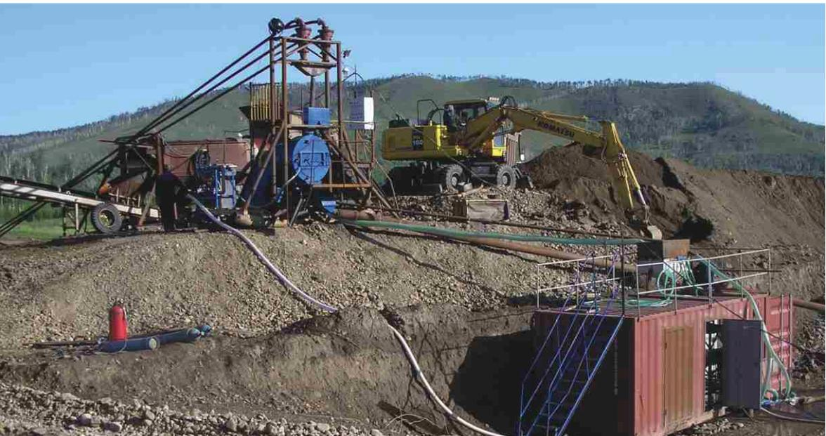
Технологический комплекс «ИТОМАК» включает скруббер-бутару с отвалообразователем, узел обогащения на основе центробежного концентратора «Итомак», передвижной доводочный комплекс, установленный в контейнере.
