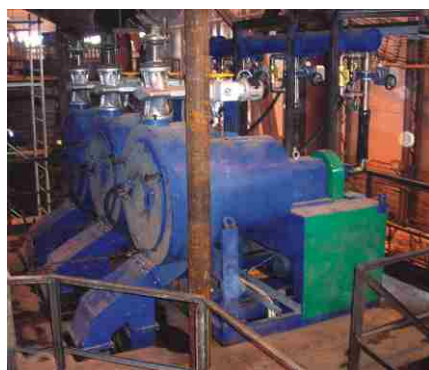
Рис. 2. Концентратор с автоматическим управлением ИТОМАК-100МКО, производительностью 100 т/ч по твердому (ЗАО «ПОЛЮС»)
