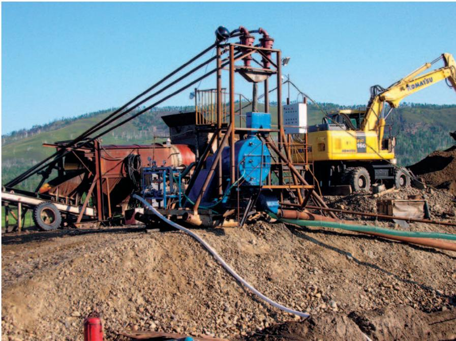
**Рисунок 4. Комплекс для добычи тонкого золота из отвалов**
