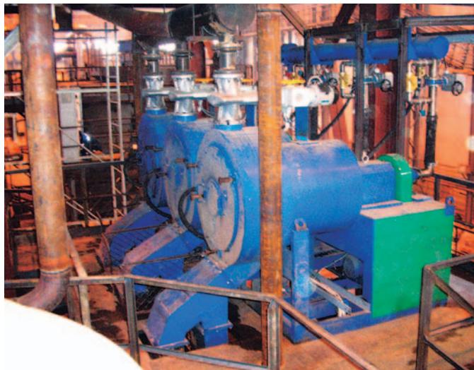
**Рисунок 3. Концентратор ИТОМАК-КГ-120 с непрерывным питанием. Автоматизированное управление**
