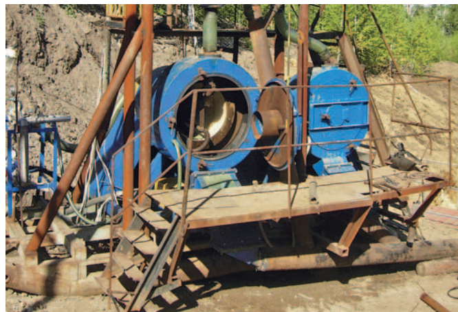
Пара концентраторов ИТОМАК для извлечения мелкого золота из лежалых хвостов на россыпях
