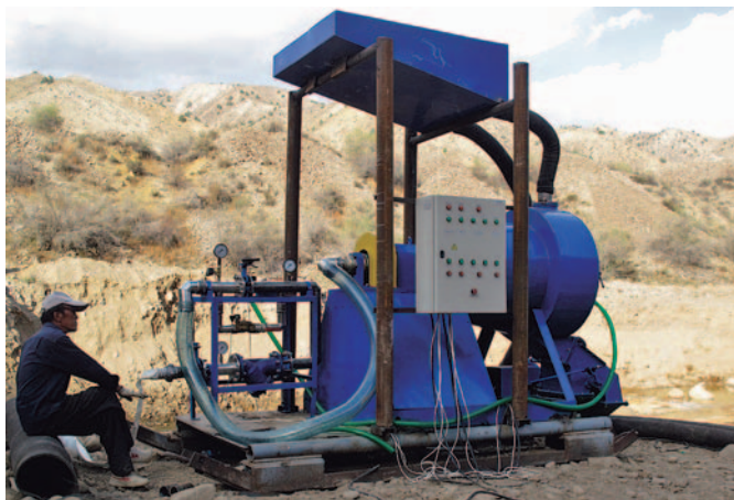
Киргизия: приставка для извлечения золота из текущих хвостов промприбора или шлюза
