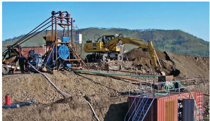
Комплекс по добычи мелкого золота из отвалов на одном из предприятий в Забайкалье
