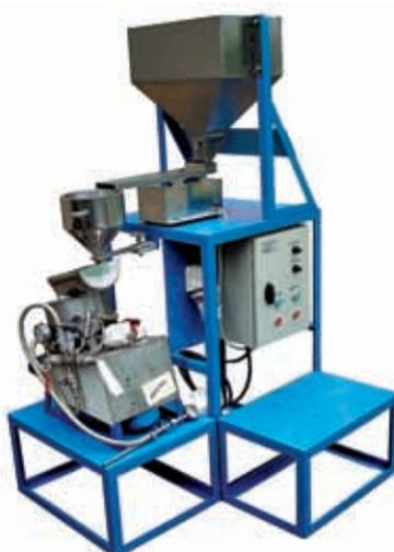
Рис. 1. Автоматизированная лабораторная установка для обогащения геологических проб
