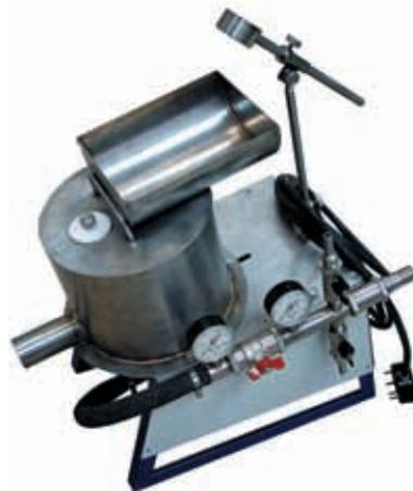
**Рис. 5.** Центробежный концентратор для сокращения геологических проб ИТОМАК-КН-0,1
