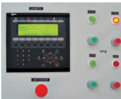
Рис. 2. Пульт управления автоматизированным концентратором
