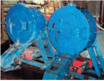
**Рис. 3.** Центробежные концентраторы с автоматическим управлением
