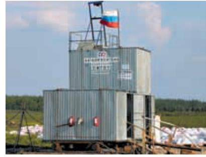
**Рис. 6.** Вертолетный вариант геологоразведочной обогатительной установки
