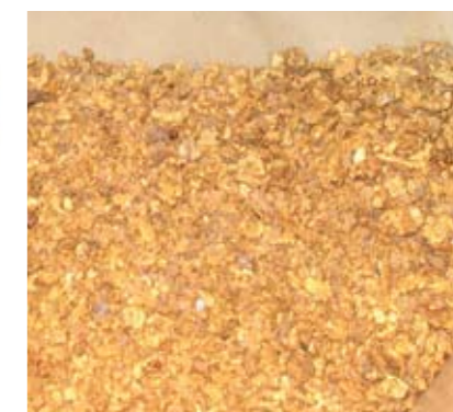
Выделенное золото на сепараторе «СМЖ-ПМ-3»
